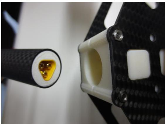
Abb. 5: Modulares Stecksystem<sup>1</sup>
