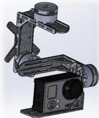
Abb. 8: Kleines 3-Achsengimbal für Kompaktkameras<sup>1</sup>
